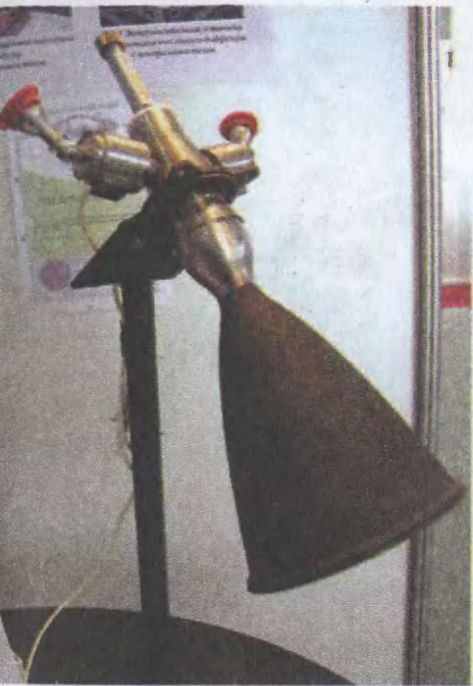
Макет ракетного двигателя с лазерным зажиганием.
